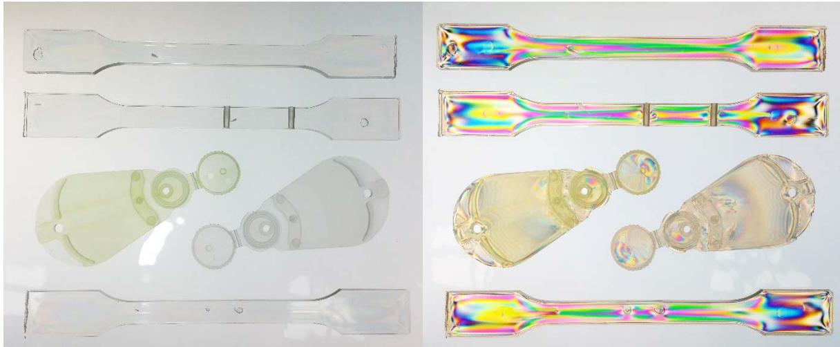
Abbildung 3.10-2 Spannungsoptik an verschiedenen Exponaten in der Anordnung eines Hellfeld-Polariskops mit linear polarisiertem Licht. Links im Bild ohne Polarisationsfilter (Analysator), rechts im Bild mit Polarisationsfilter vor der Aufnahmelinse, zu sehen sind die im Bauteil eingefrorenen Eigenspannungen
