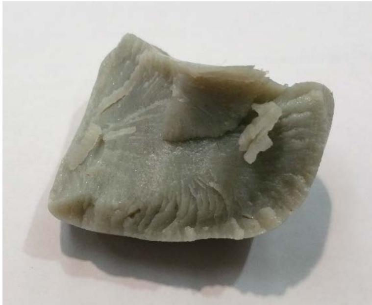
Abbildung 3.5-2 Sprödbbruch des Silly Putty durch hohe Belastungsgeschwindigkeit nach einem Schlag mit dem Hammer
