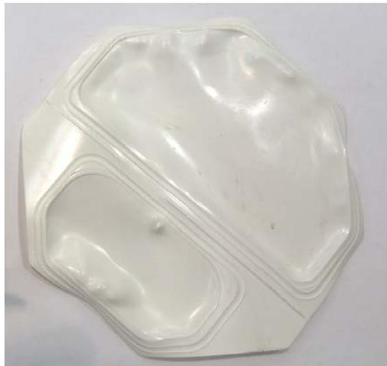
*Abbildung 3.3-2 Joghurtbecher nachdem dieser in seine nahezu ursprüngliche Form zurückversetzt wurde*
