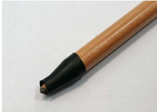
Abbildung 3.4-2 Schrumpfschlauch nach der Erwärmung an einer Bleistiftspitze
