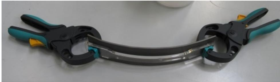
Abbildung 3.7-2 Einspannung in Variante A
