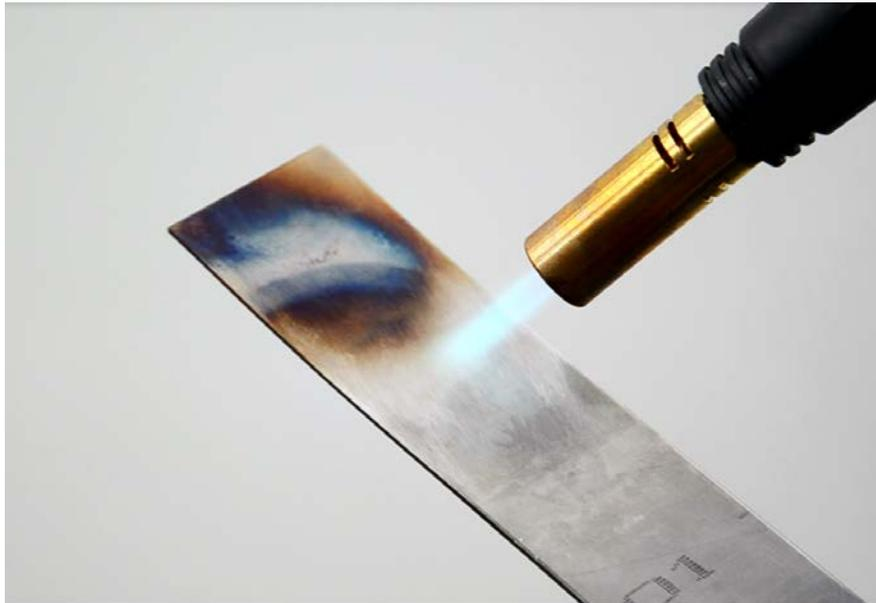
Abbildung 2.6-3 Versuchsdurchführung mit sichtbaren Anlauffarben in der Wärmeeinflußzone
