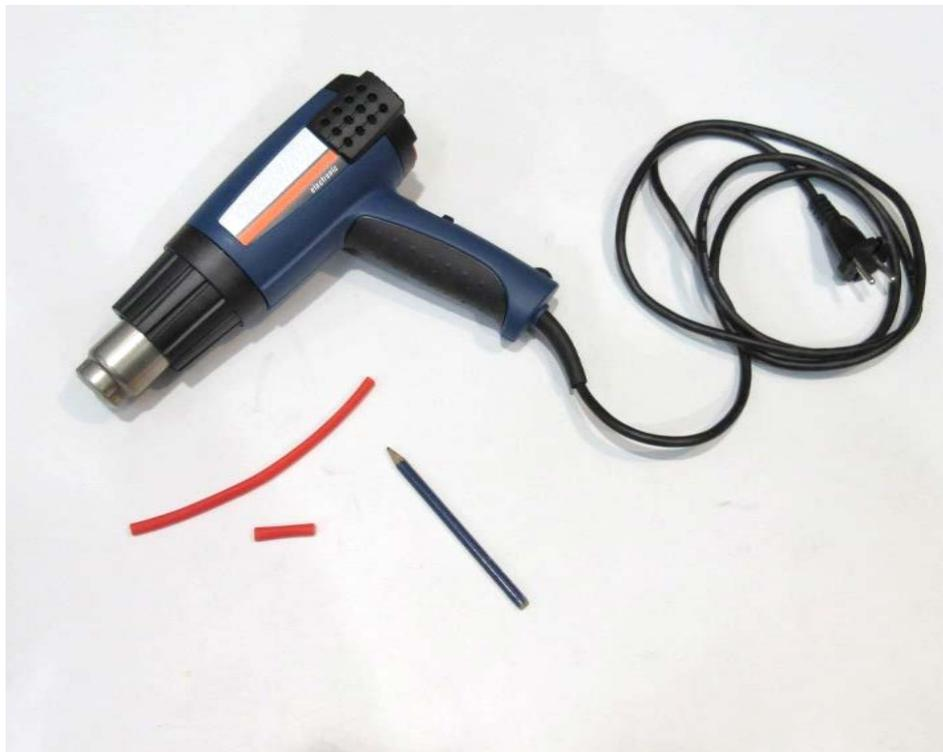
Abbildung 3.4-1 Ausrüstung und Geräte (Heißluftföhn, Schrumpfschlauch und ein Bleistift)
