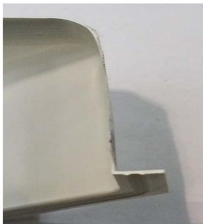
*Abbildung 3.3-3 Wandstärkenunterschiede aufgrund des Thermoformens*
