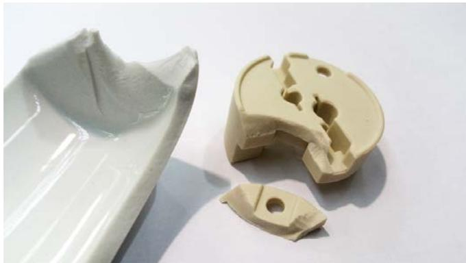
Abbildung 2.3-4 Trenn- bzw. Sprödbrüche an keramischen Werkstoffen (vgl. Abbildung 2.3-3, rechts)
