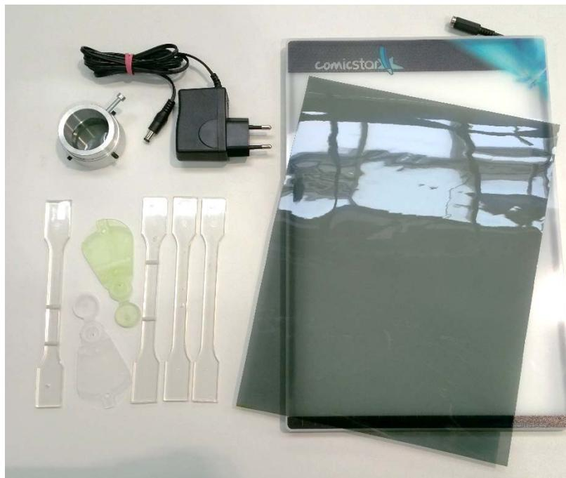
Abbildung 3.10-1: Geräte zur Visualisierung der Eigenspannungen
