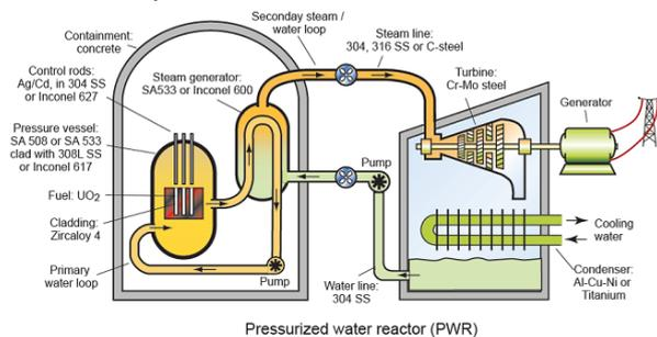
Figura 2: Funcionamento de um PWR
