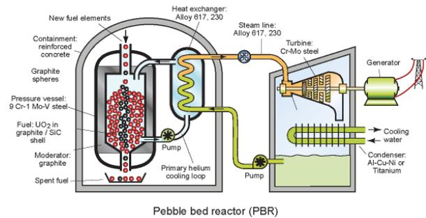
Figura 1: Funcionamento de um PBR
