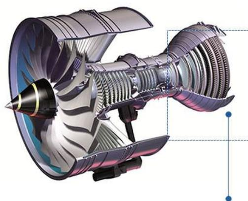
Turbina de Baja Presión (Diseño, Fabricación y Montaje):
